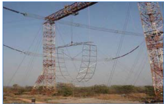
Fig. 1(d) : 1200 kV tower window simulation
